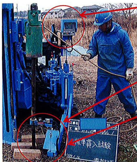
掘削深度、N値等の計測値を確認できるモニター
