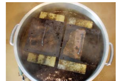
接着重ね梁の接着性能試験
