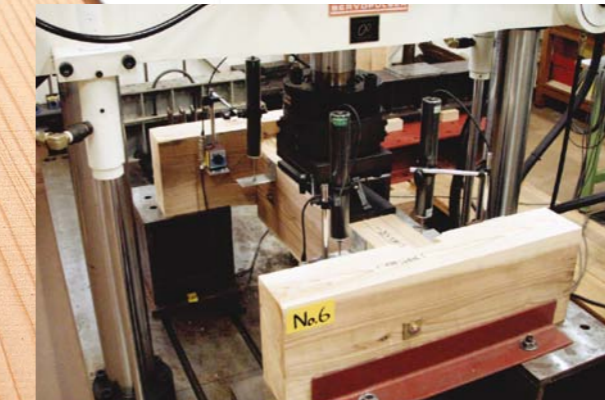
接合部の強度性能試験
