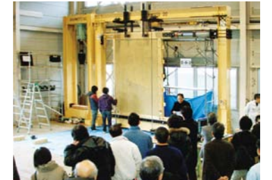
土壁の耐力試験
