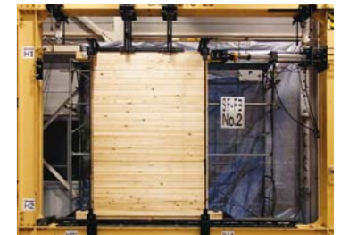
床構造体の水平耐力試験
